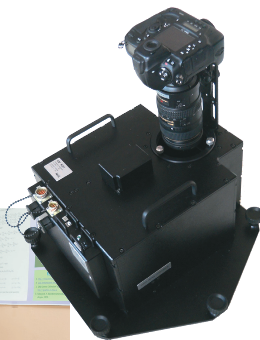
Сістэма арыентацыі відэаспектральнай апаратуры (скарочана «САВА»)
