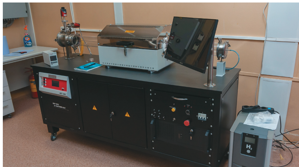
Устаноўка сінтэзу графену, створаная ў НДІ ядзерных праблем на замову рэзідэнта парка «Вялікі камень» ТАА «Кітайска-беларускі высокатэхналагічны аэракасмічны цэнтр даследаванняў і распрацовак»
